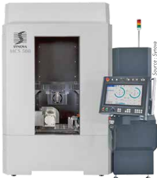
La MCS 500 est une machine Synova de découpe laser dédiée à l'industrie de l'aviation.
