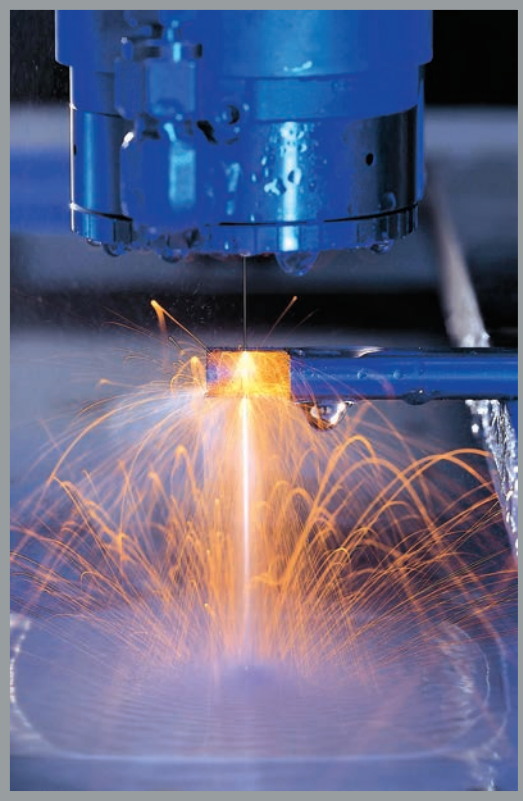
Bild 3. Das Laser-MicroJet-Schneiden eignet sich besonders gut für die Werkzeugbearbeitung
