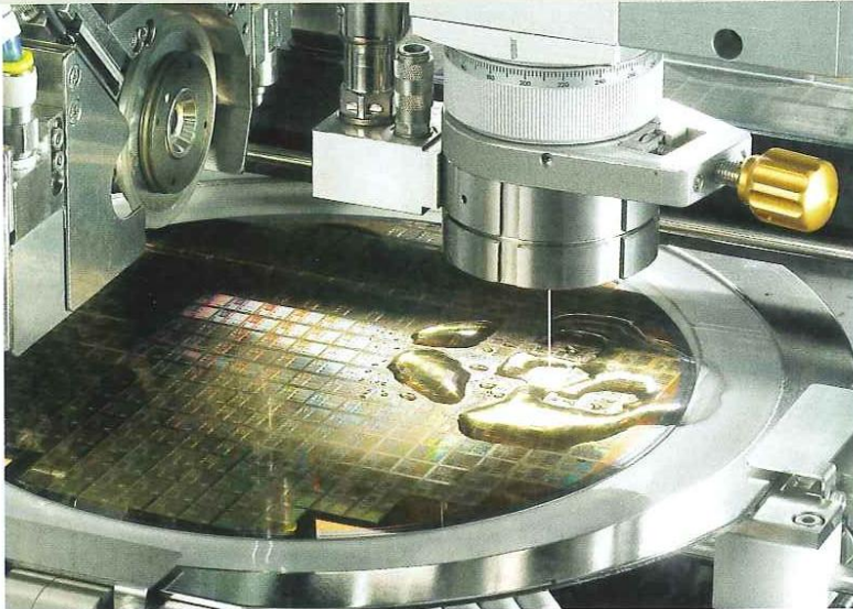
Bild 1. Der Microjet-Laser kombiniert mit einem Wafer-sägesystem auf einer hybriden Dicingmaschine für Halbleiter. Die Beschädigungen auf dem Siliziumwafer sind minimal
