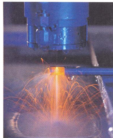
Exemple de découpe d'un tube par le procédé Laser Microjet.
