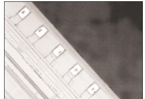
Fig. 3. No chipping on the die edge
