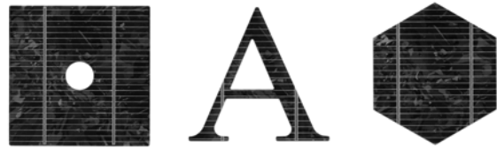
Bild 4 Beispiele für konturgeschnittene Solarzellen mit dem Laser-Microjet®
